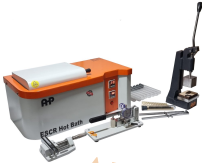
ESCR Test Setup ASTM D 1693
